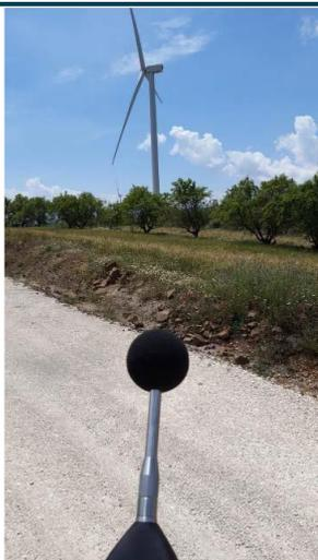
Fig. 1 Medición acústica en MO2.05. Fuente: Elaboración propia
