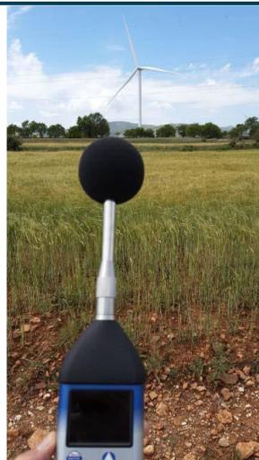
Fig. 2 Medición acústica en MO2.04. Fuente: Elaboración propia
