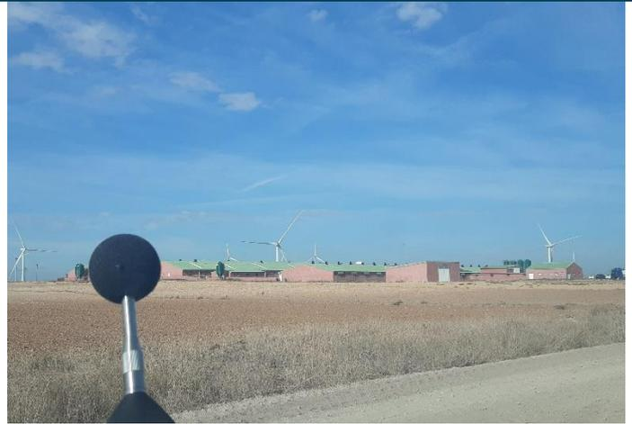
Fig. 2 Medición acústica en granja Muga 1. Fuente: Elaboración propia
