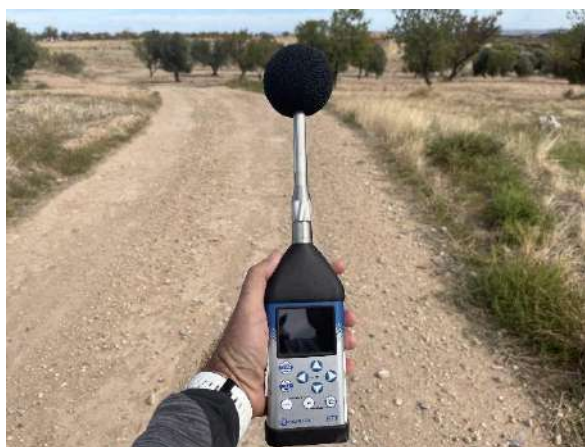
Figura 17: Sonómetro integrador modelo clase 1 SVAN 977 utilizado para la evaluación de los niveles de presión sonora en el parque eólico.
