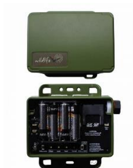
Figura 22. Mini Bat: vista del interior (a) y del exterior (b). Fuente: WildLife Acoustics.
