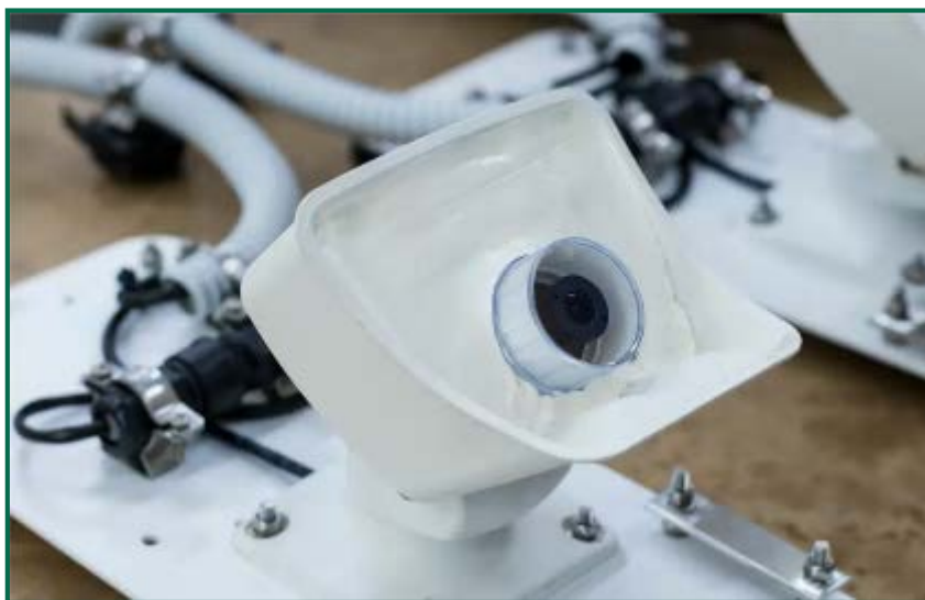
Fotografía 8. Nuevas carcasas para las cámaras de detección de DtBird.
