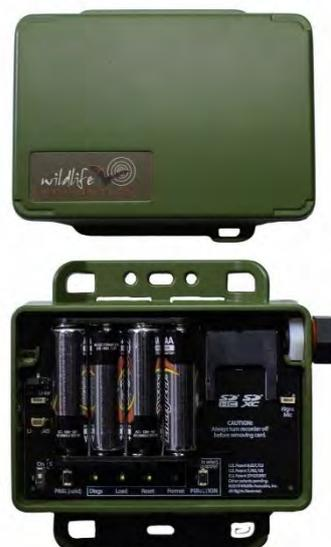
Figura 31. Mini Bat: vista del interior (a) y del exterior (b). Fuente: WildLife Acoustics.
