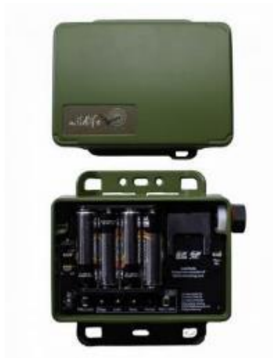
Figura 26. Mini Bat: vista del interior (a) y del exterior (b). Fuente: WildLife Acoustics.
