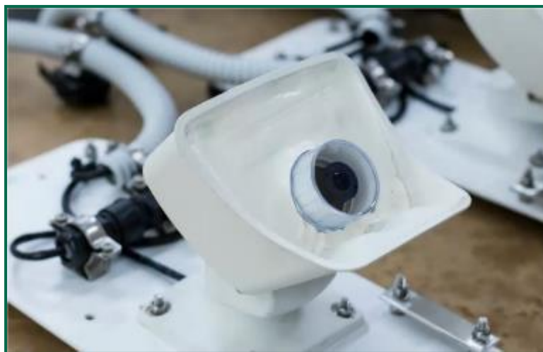
Fotografía 20. Nuevas carcasas para las cámaras de detección de DtBird.
