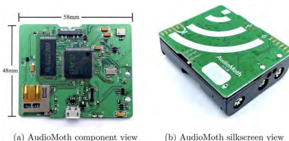
Figura 21. Audiomoth: vista del interior (a) y del exterior (b). Fuente: Hill et al. (2019).
