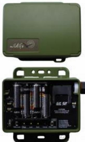
Figura 23. Mini Bat: vista del interior (a) y del exterior (b). Fuente: WildLife Acoustics.
