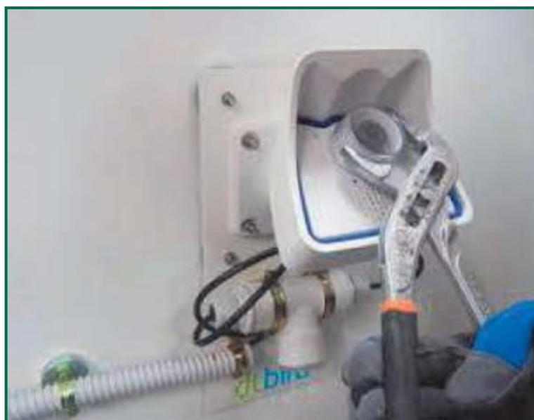
Fotografía 23. Cubrelente acoplado a la nueva cámara.
