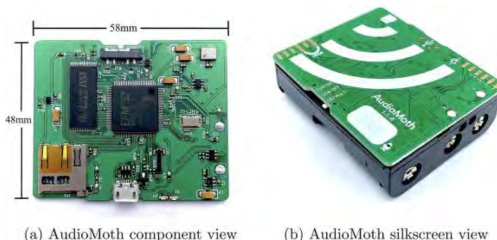
Figura 24. Audiomoth: vista del interior (a) y del exterior (b). Fuente: Hill et al. (2019).
