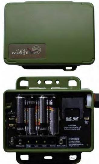
Figura 21. Mini Bat: vista del interior (a) y del exterior (b). Fuente: WildLife Acoustics.
