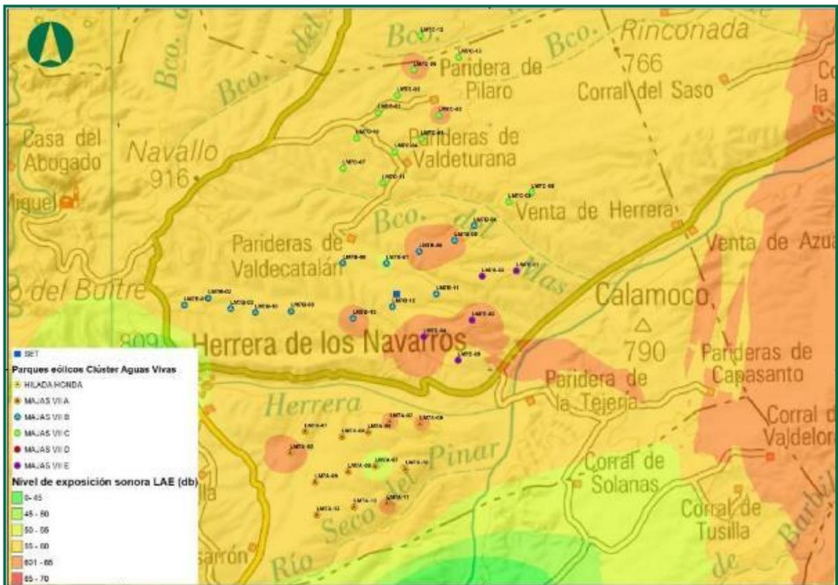
Figura 48. Distribución espacial hallada mediante dos tipos de interpolación diferentes (IDW) de los datos medidos en campo con una velocidad de viento entre 5 y 8 m/s y parques eólicos en funcionamiento.
