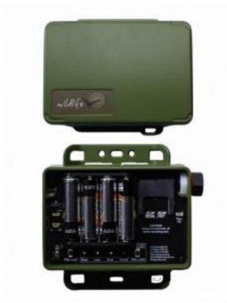
Figura 26. Mini Bat: vista del interior (a) y del exterior (b). Fuente: WildLife Acoustics.
