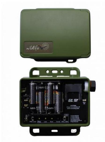
Figura 24. Mini Bat: vista del interior (a) y del exterior (b). Fuente: WildLife Acoustics.
