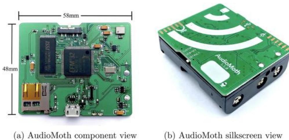
Figura 22. Audiomoth: vista del interior (a) y del exterior (b). Fuente: Hill et al. (2019).
