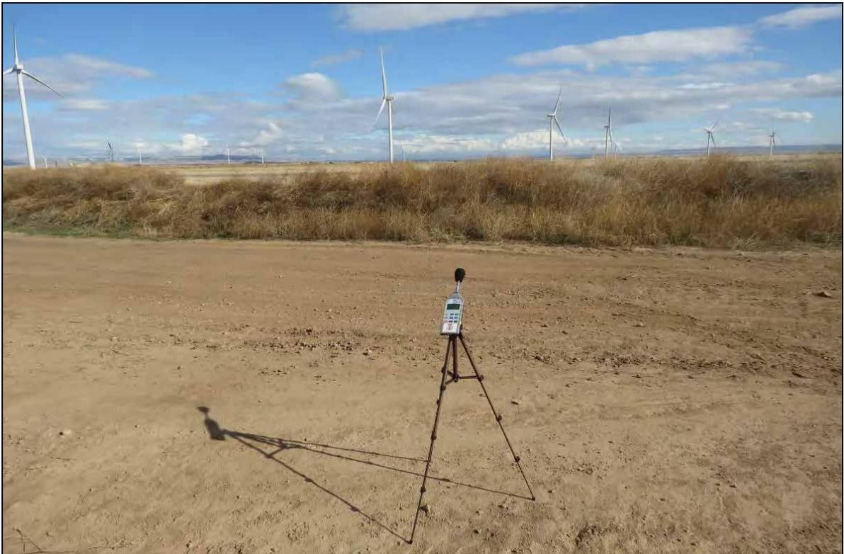
Imagen 39. Sonómetro y mediciones en PE La Nava. Fuente propia.
