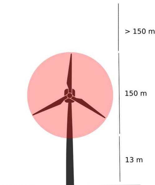
Figura 3. Rango de alturas para aerogeneradores de "La Cometa II". Fuente: Ideas Medioambientales S.L.
