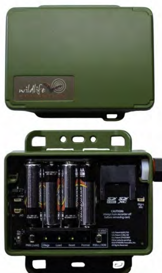
Figura 10. Mini Bat: vista del interior (a) y del exterior (b). Fuente: WildLife Acoustics.
