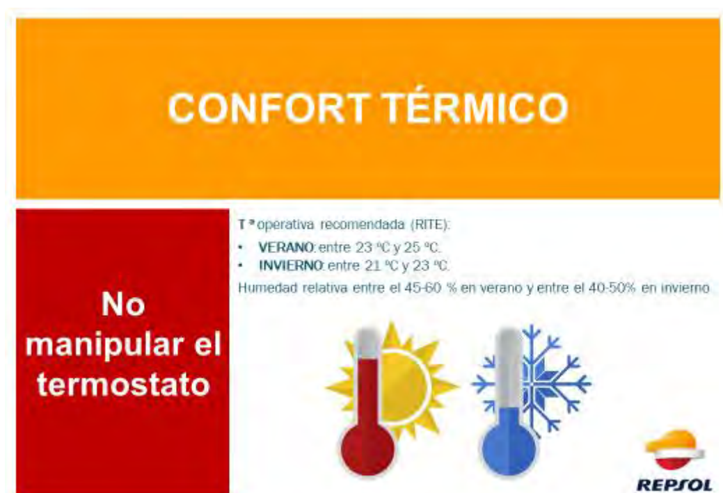
Figura 24. Señalización temperatura termostato en las SET.
