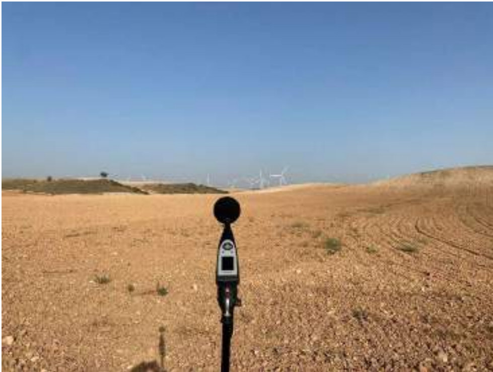
Foto nº5. Medición del ruido diurno en el punto de medición RPC-08.
