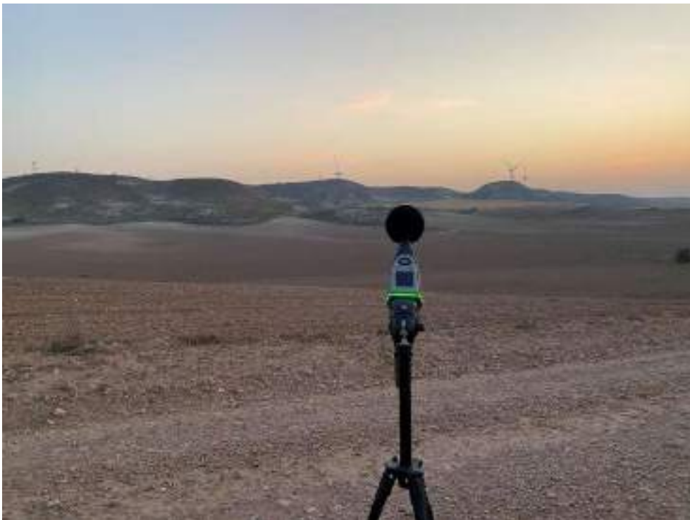
Foto nº6. Medición del ruido diurno en el punto de medición RPC-09.
