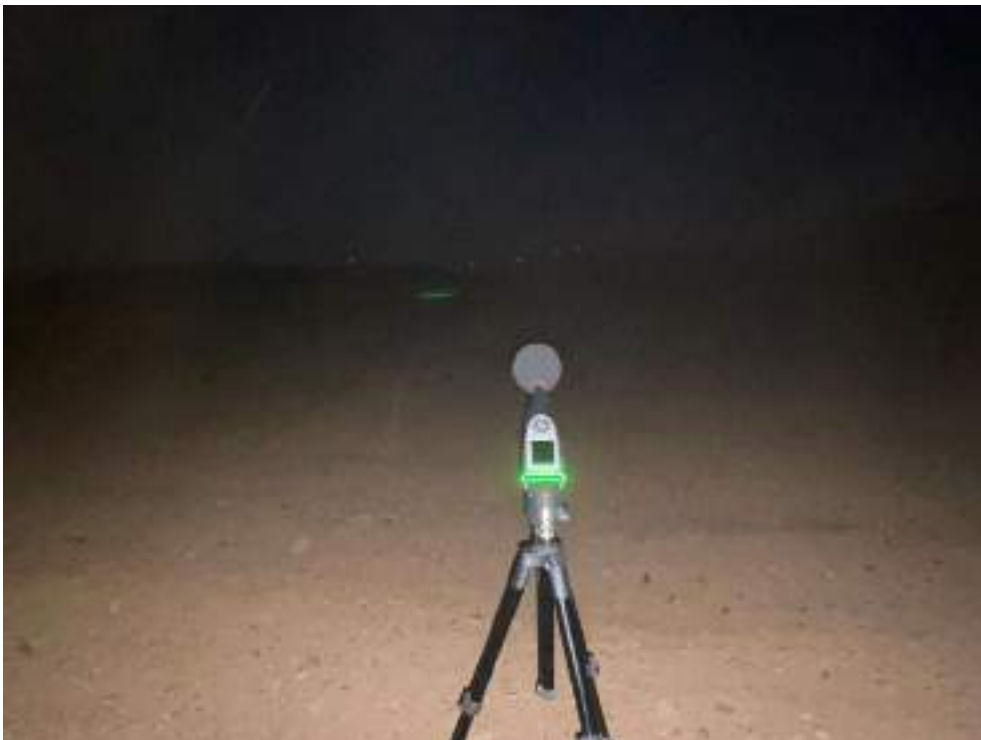
Foto nº4. Medición del ruido nocturno en el punto de medición RPC-08.
