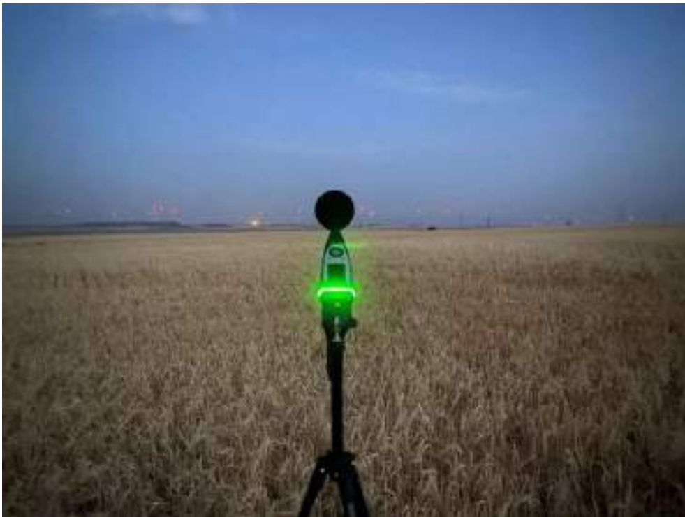
Foto nº2. Medición del ruido de fondo nocturno en el punto de medición RFPE-02.
