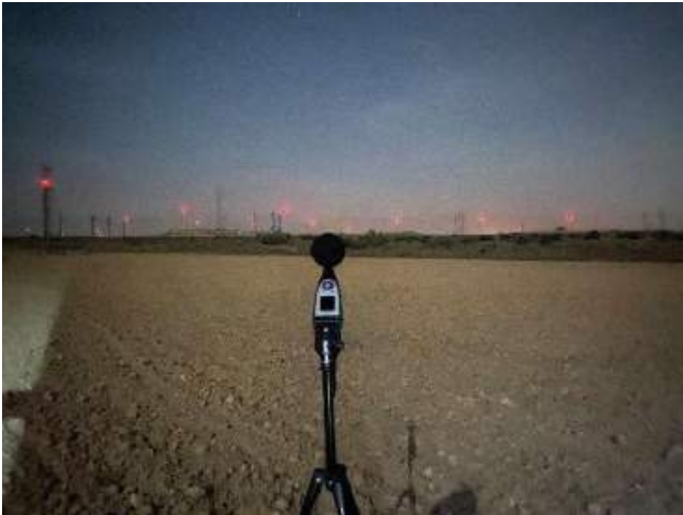
Foto nº3. Medición del ruido nocturno en el punto de medición RPC-06.
