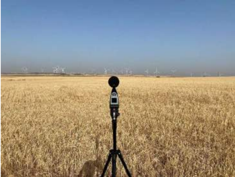
Foto nº1. Medición del ruido de fondo diurno en el punto de medición RFPE-02.
