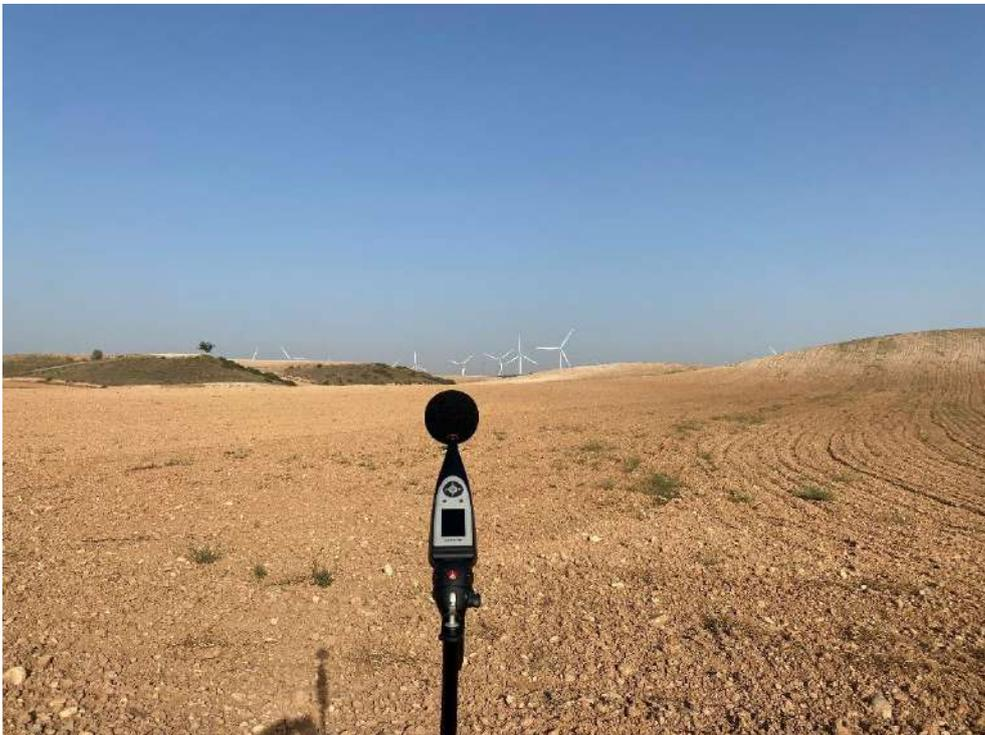
**Foto nº4.** Medición del ruido diurno en el punto de medición RPA-08.
