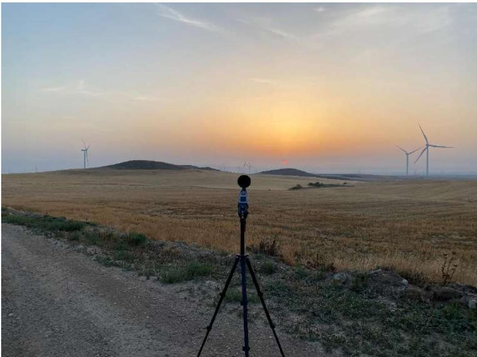
**Foto nº6.** Medición del ruido diurno en el punto de medición RPA-10.
