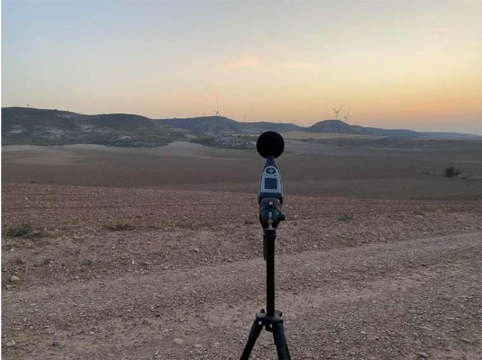
**Foto nº5.** Medición del ruido diurno en el punto de medición RPA-09.
