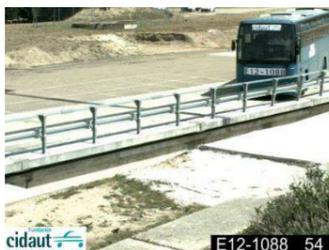
**Ensayo:** TB51 (vehículo pesado de 13.000 Kg. a 70 Km/h y 20°)
