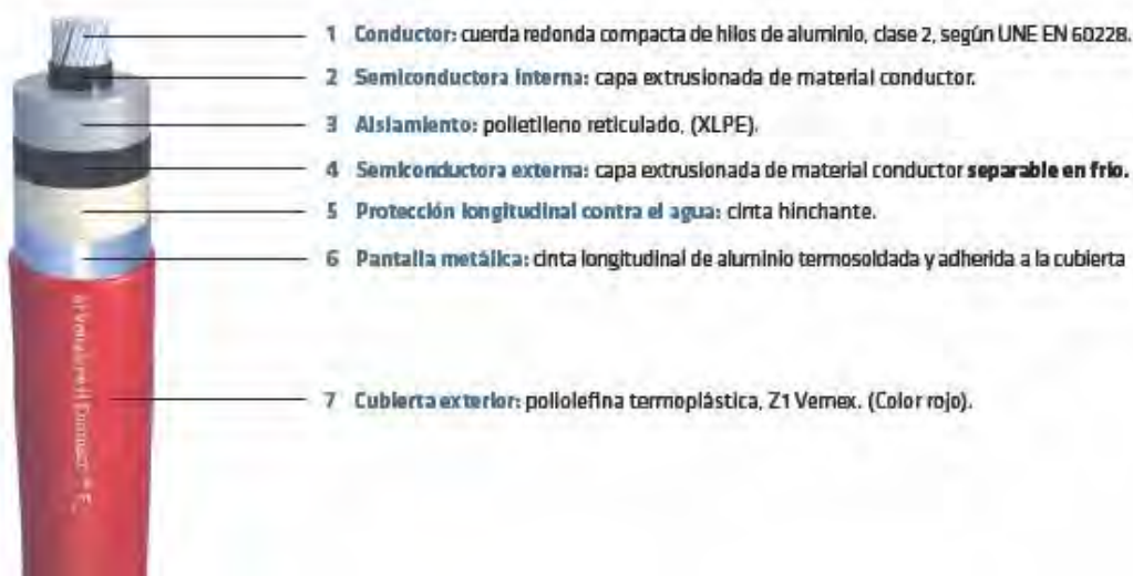
Ilustración 2: Cable AI Voltalene H Compact (Normalizado por Endesa, nuevo diseño) AI RH5Z1 7
