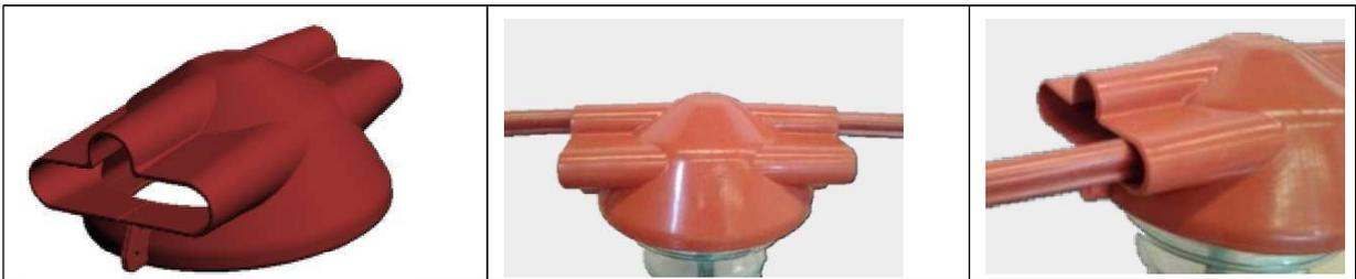
Se trata de un protector pensado para cubrir conductores montados sobre aisladores de vidrio. Puede ser montado sobre aisladores de vidrio tipo ARVI-32 y, opcionalmente, puede ser usado en ARVI-42 y en aisladores rígidos de porcelana presentes en líneas de distribución de hasta 36 Kv.
