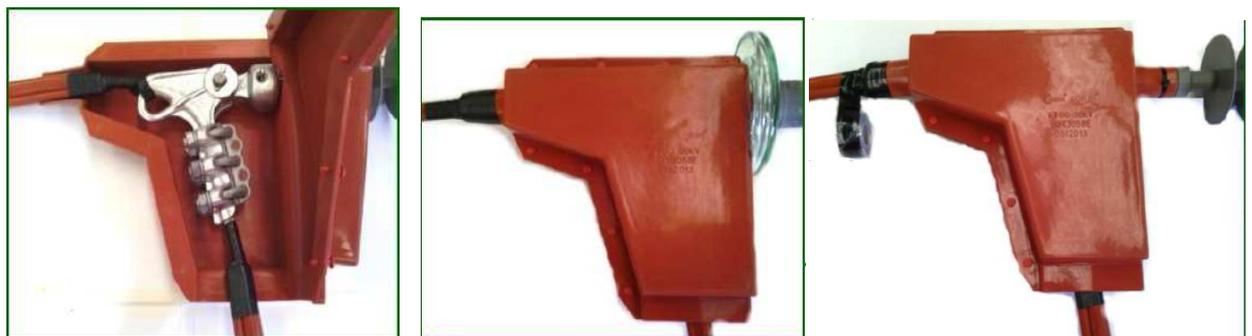
Diseñado para cubrir con funda aislante las rótulas metálicas y las grapas de amarre del tipo GA-1 y GA-2, con rango de conductores de diámetro 6 a 16 mm., en líneas de distribución de hasta 36 Kv. Con un espesor de 3.5 mm. de silicona, es un dispositivo con la rigidez dieléctrica necesaria y suficiente para garantizar un rendimiento satisfactorio de por vida. Además, su diseño permite una instalación en tendidos existentes de modo sencillo, manual y sin necesidad de herramientas.
