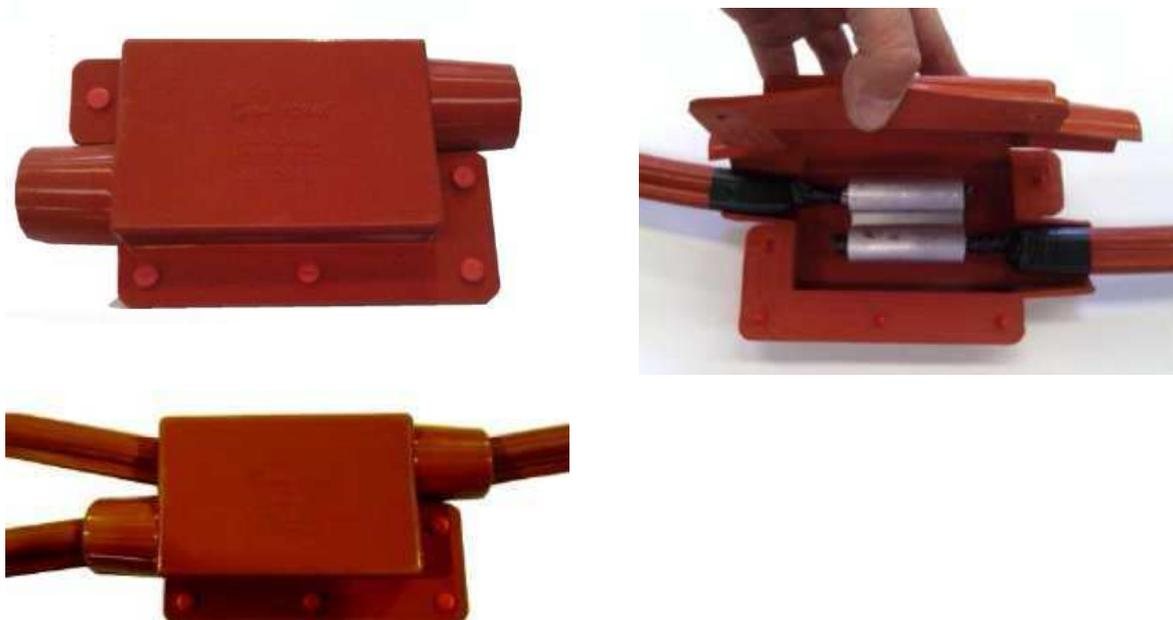
El espesor de silicona utilizado es 3.5 mm confiere al dispositivo la rigidez dieléctrica necesaria para redes de hasta 36 Kv, así como un rendimiento eficaz en el tiempo. Existen productos equivalentes para tendidos de 2ª categoría de hasta 66 Kv.
