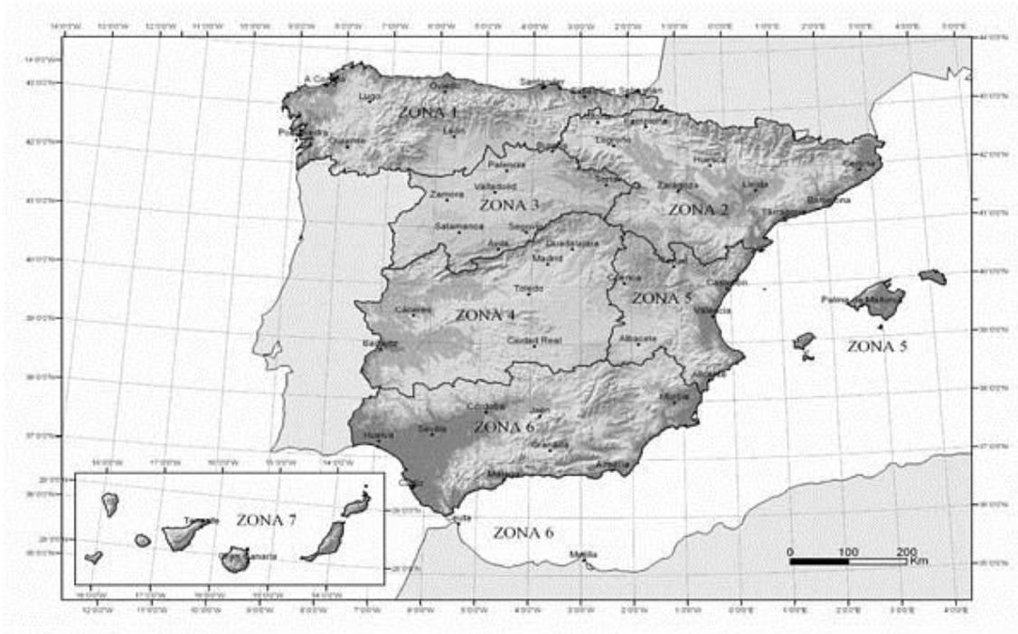
Figura 2. Zona climática en función de la altitud, según el Documento Básico SE-AE.
