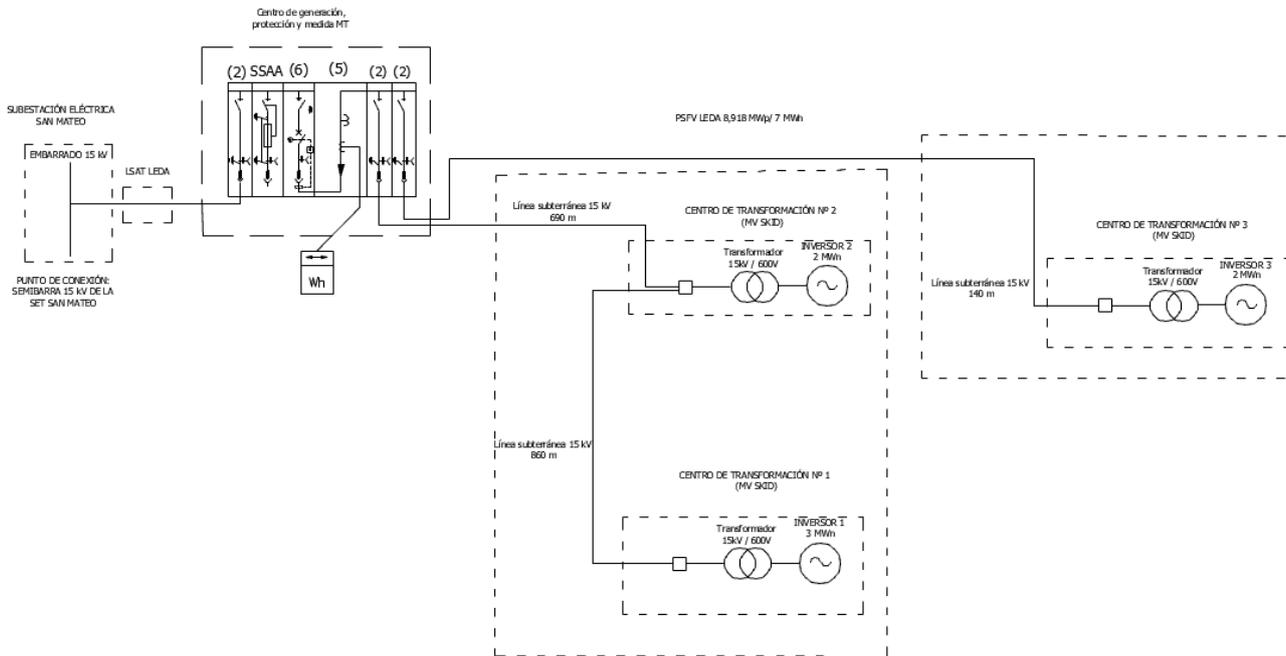
**Ilustración 1. Esquema de la instalación.**
