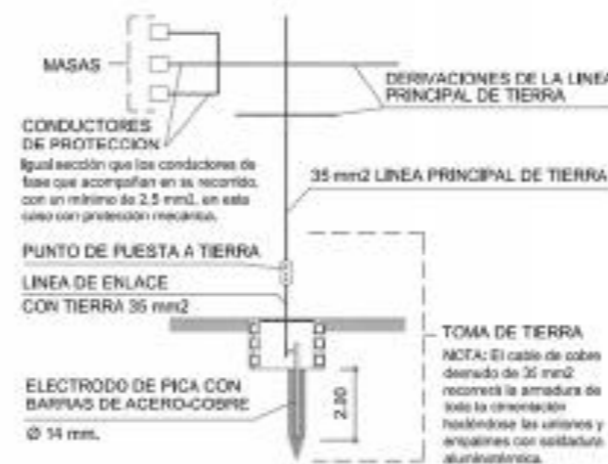
ESQUEMA DE PUESTA A TIERRA
