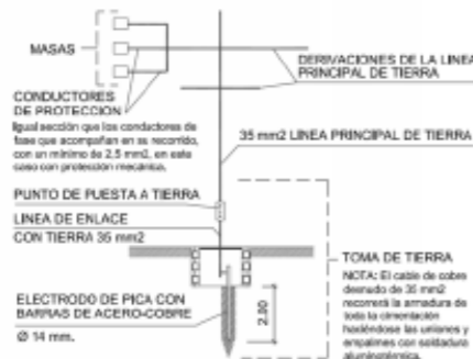
ESQUEMA DE PUESTA A TIERRA
