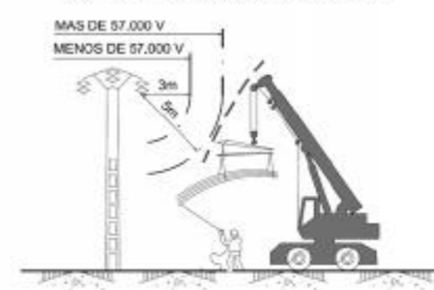
INTERFERENCIA DE GRUA CON LINEA ELECTRICA AEREA DE A.T.
