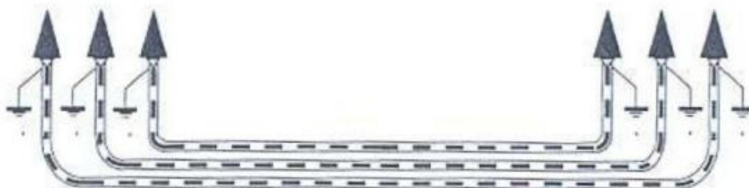
**Figura 8: Puesta a tierra de cubiertas metálicas.**
