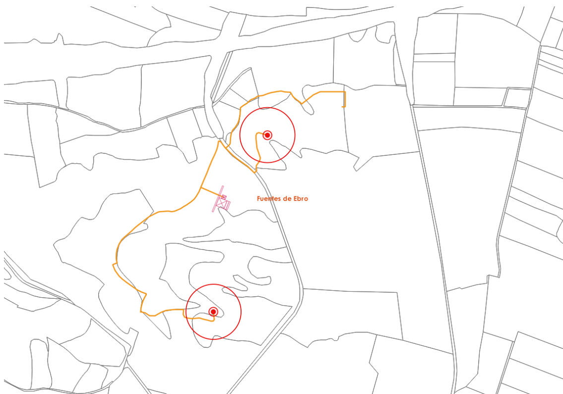
Imagen4. Trazado de las zanjas para alojar las líneas subterráneas
