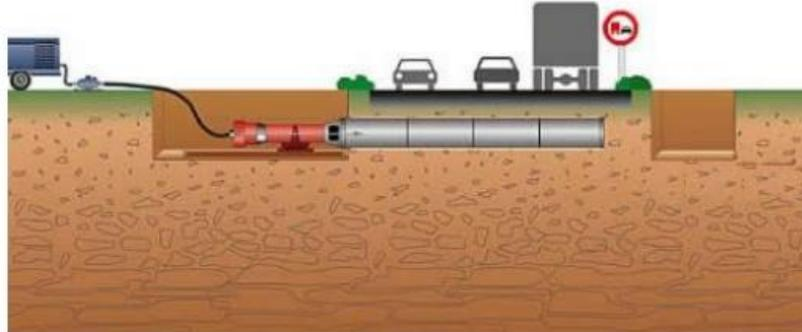
La perforación mecánica horizontal se trata de un sistema mediante el cual desde un foso de ataque donde se ubica la máquina se realiza la perforación desde la cota deseada hasta el foso de salida. Con este sistema, al mismo tiempo que se va instalando la tubería de acero se va extrayendo el material mediante un sinfín.
