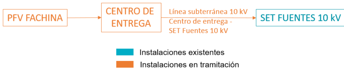
Ilustración 1: Infraestructuras de evacuación
