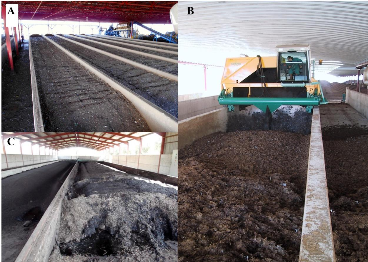
Otra de las limitaciones o debilidades de este sistema está en la captación de lixiviados, ya que acceder al fondo de las trincheras para comprobar periódicamente su estado requiere vaciarlas completamente, algo que conlleva un esfuerzo y coste importante. Por ello, desde el diseño inicial hasta el protocolo de trabajo en planta, se debe considerar que este es un factor muy relevante para asegurar la eficiencia y buen funcionamiento de la instalación.
