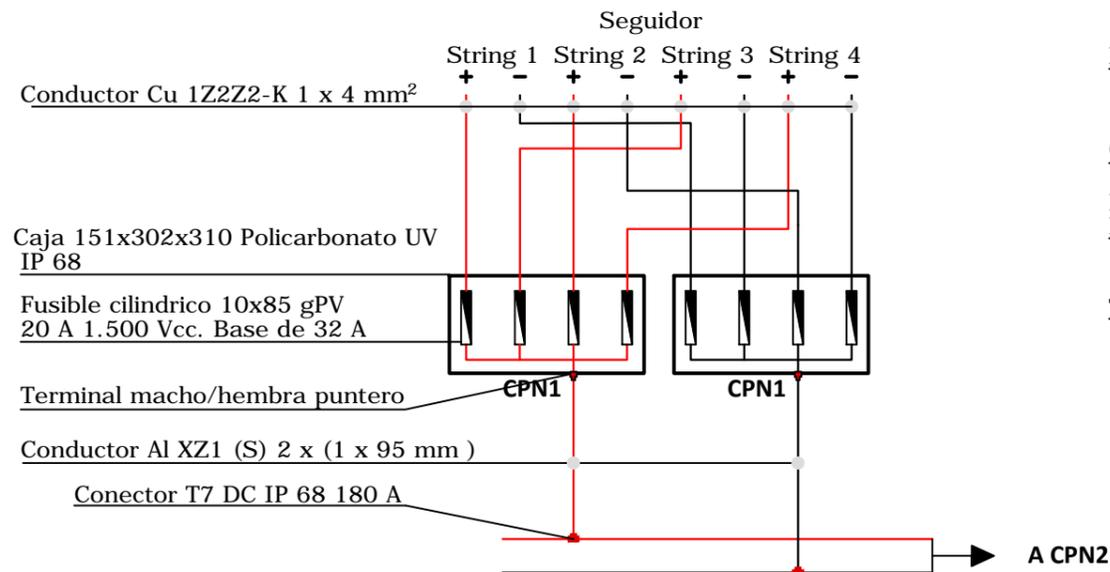
Circuito de 1.500 V c.c. Conductor AL XZ1 (S) 2 x (1 x 95 mm<sup>2</sup>) en el eje del seguidor
