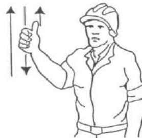
4 Levantar el aguilón o pluma lentamente
