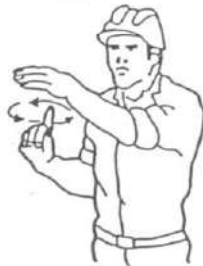
3 Levantar la carga lentamente
