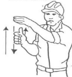
4 Levantar el aguilón o pluma lentamente
