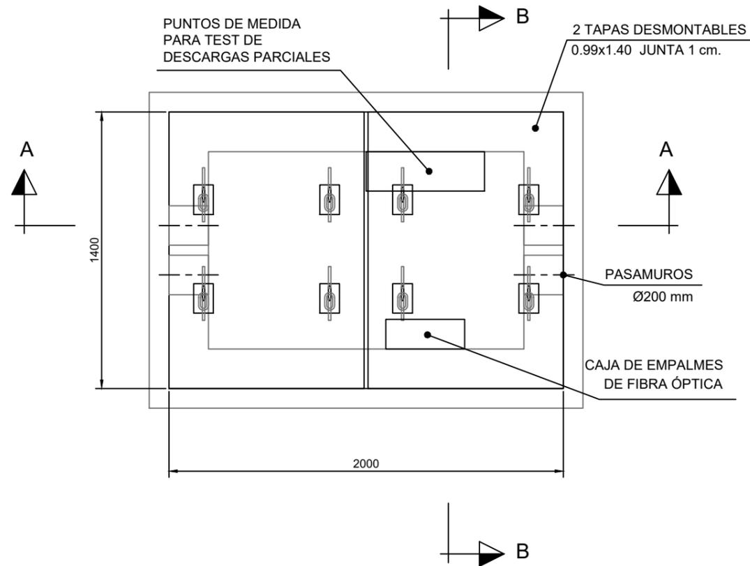
NOTA: LOS PUNTOS DE MEDIDA PARA LOS TEST DISTAN 2 KM Y LAS CAJAS DE EMPALMES DE FIBRA ÓPTICA, CADA 4 KM, POR LO QUE EN TRAMOS CON DISTANCIAS MAYORES A 2 KM, TENDREMOS UNA ARQUETA TIPO 1 CADA 2 KM Y EN TRAMOS CON DISTANCIAS MAYORES A 4 KM TENDREMOS UNA ARQUETA TIPO 1 CADA 2 KM Y OTRA ARQUETA TIPO 2 CADA 4 KM, INTERCALADAS.
