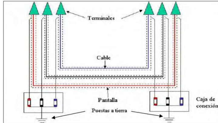
En este tipo de conexión, se inducen corrientes de circulación en las pantallas de los cables, provocando pérdidas por calor y consecuentemente pérdidas en la intensidad admisible del cable. Estas pérdidas, se pueden minimizar cuando los cables están dispuestos en formación tresbolillo, sin embargo, se incrementan con la separación de los mismos.
