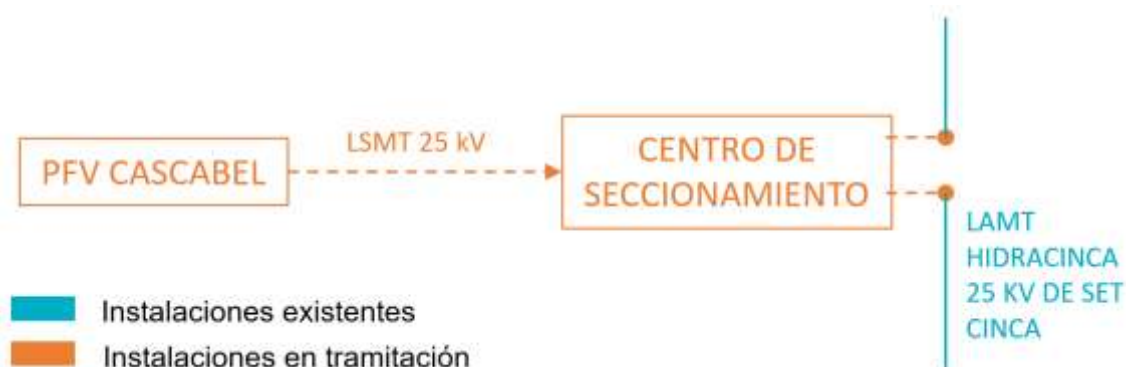
Ilustración 4: Infraestructuras de evacuación
