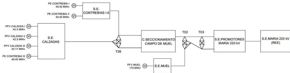
El objeto del proyecto es la descripción de la Línea Aérea de Alta Tensión 220 kV S.E. "Contrebias I-II" – Centro Seccionamiento "Campo de Muel" para la evacuación de la energía eléctrica generada en los Parques Eólicos "Contrebia I" (49.4 MW) y "Contrebia II" (49.4 MW).
