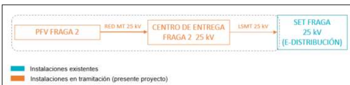
Figura 2. Esquema de la evacuación de la energía generada en el proyecto.
