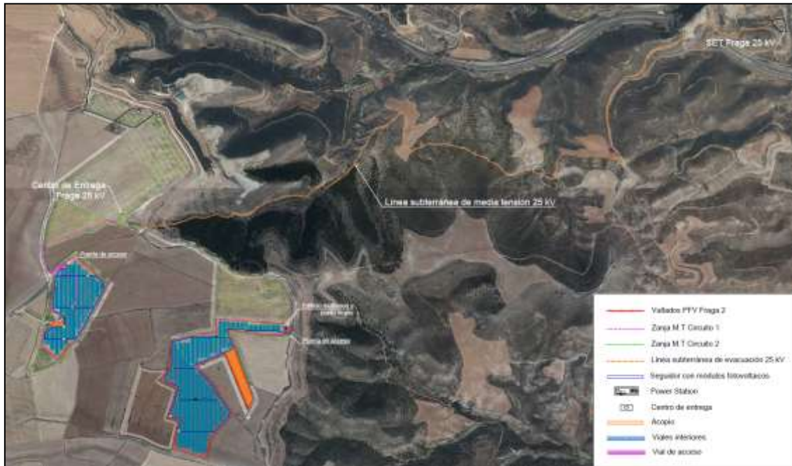
Figura 4. Línea subterránea de media tensión de PFV Fraga 2 a SET Fraga.
