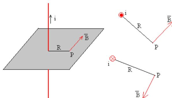
En la figura, se muestra la dirección y sentido del campo magnético producido por una corriente rectilínea indefinida en el punto P. Cuando se dibuja en un papel, las corrientes perpendiculares al plano del papel y hacia el lector se simbolizan con un punto en el interior de una pequeña circunferencia, y las corrientes en sentido contrario con una cruz en el interior de una circunferencia tal como se muestra en la parte derecha de la figura.
