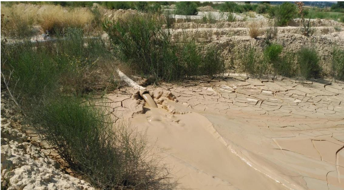
Foto 5. Momento de descarga de los lodos espesados a las balsas.
