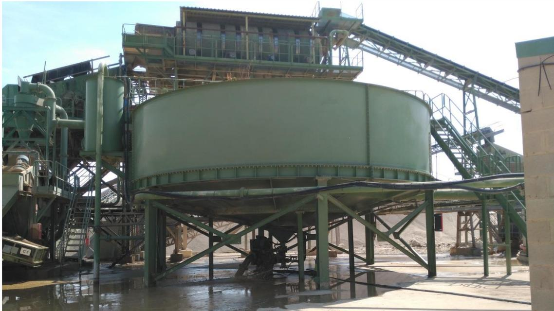
Foto 7. Tanque de clarificación del material que descarga el hidrociclón.
