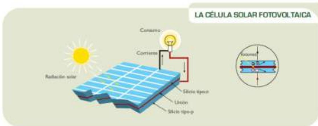
Ilustración 7. La célula solar fotovoltaica. (Fuente: ITC)
