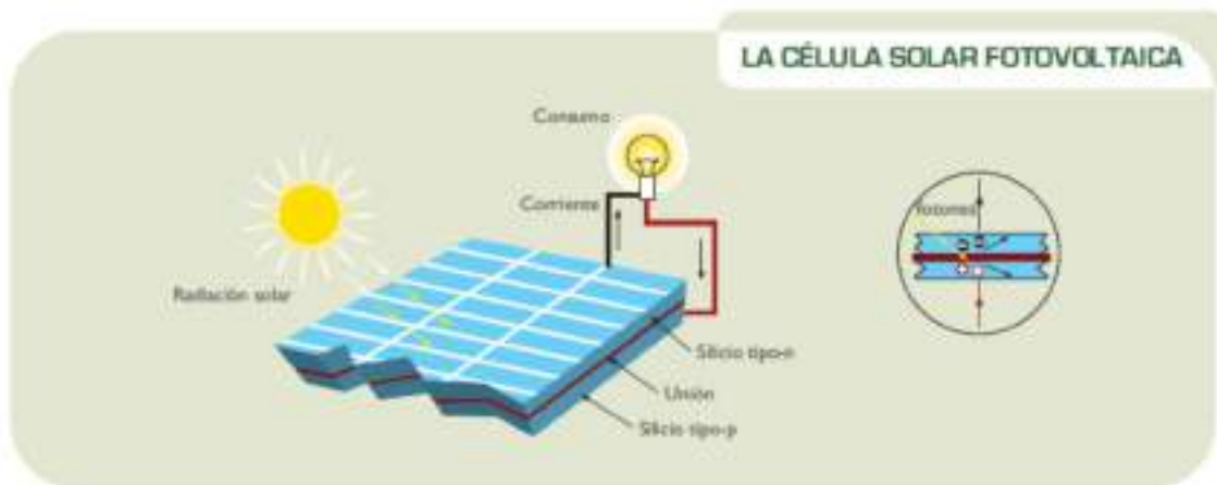
Ilustración 7. La célula solar fotovoltaica. (Fuente: ITC)
