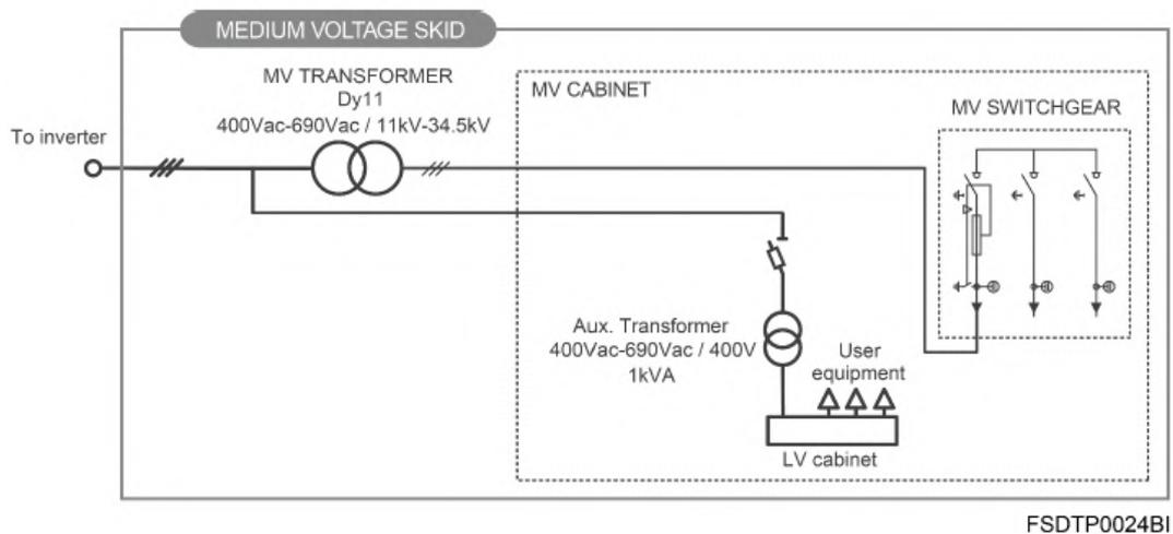
Figura 4 – Diagrama operacional Freesun MV SKID Frame 2.
