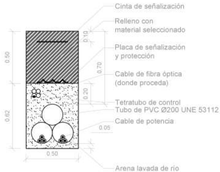
Ilustración. Zanja para tramo Entrada y Salida
