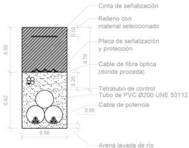
Ilustración. Zanja para tramo Entrada y Salida
