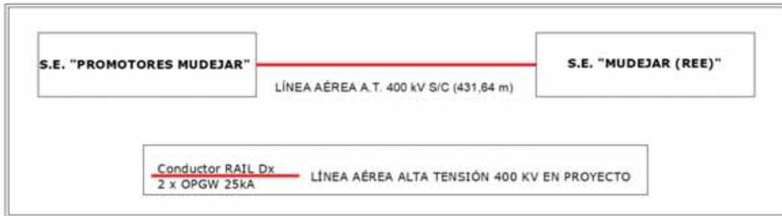
Esquema de la instalación proyectada: LAT 400kV
