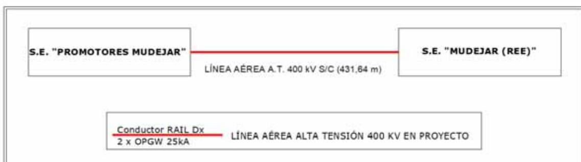
**Esquema de la instalación proyectada: LAT 400kV**
