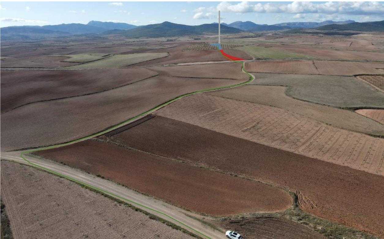
Fotografía 5: Vista de la zona de la zona de ubicación del aerogenerador del parque eólico Valdejalón II desde el parque eólico Los Visos. En azul la zona de ubicación de la plataforma (en zona de almendros), en rojo el vial de acceso desde la carretera A-121 adyacente, en gris ubicación del aerogenerador, y en verde zanja de evacuación de energía hasta la SET Los Visos, la cual va en todo su trazado por viales existentes.
