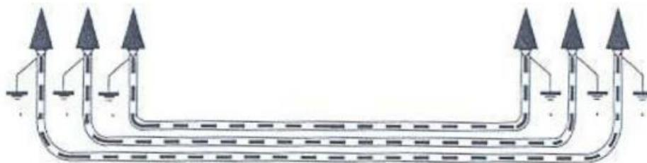
**Figura 5: Puesta a tierra de cubiertas metálicas**
