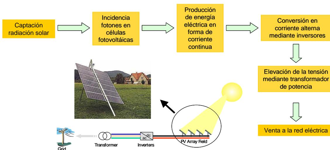
Figura 4: Principio de funcionamiento
