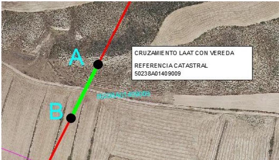
Figura 8. *Detalle afección de la línea con camino*
