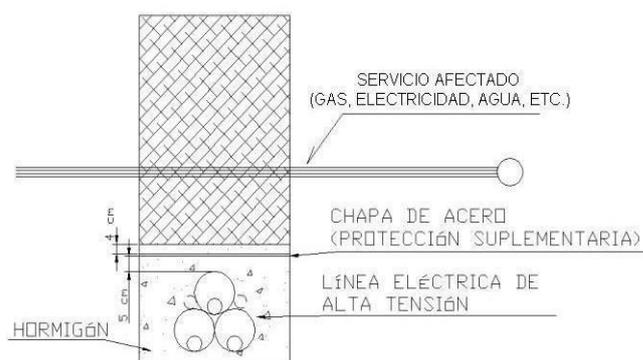
Figura 13. Cables de energía eléctrica
