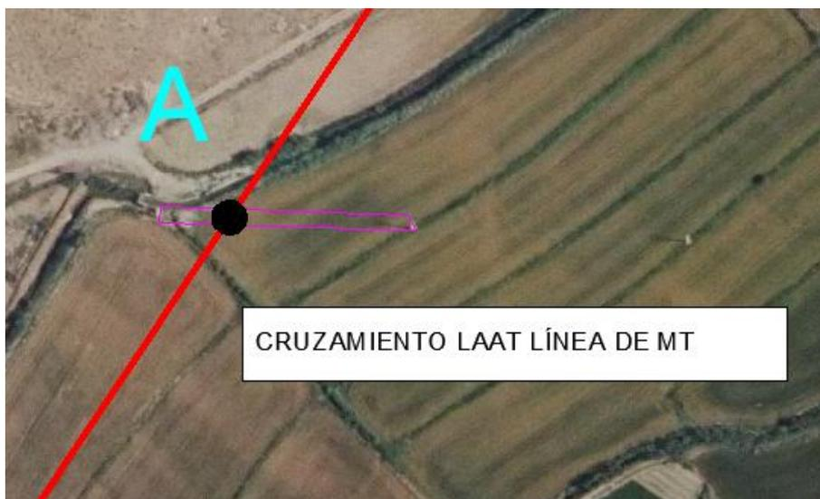
Figura 17. Detalle afección de la línea con línea de MT
