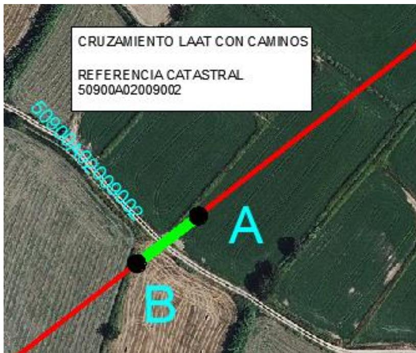
Figura 16. Detalle afección de la línea con camino
