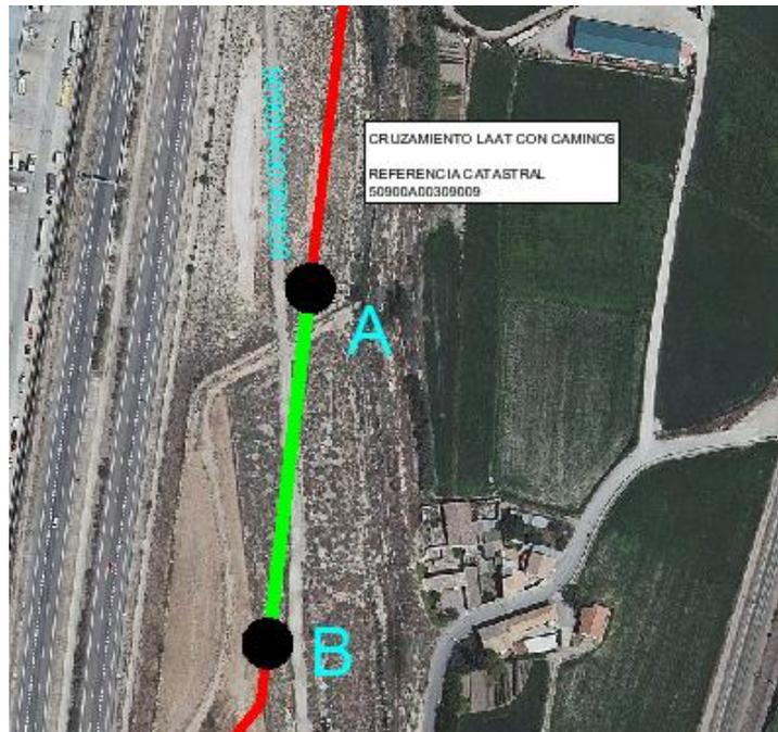
Figura 22. Detalle afección de la línea con camino
