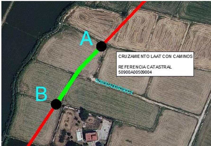
Figura 23. Detalle afección de la línea con camino
