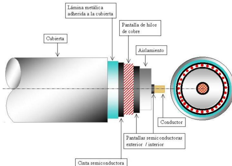
Figura 10. : Componentes de conductor de la línea subterránea de evacuación
