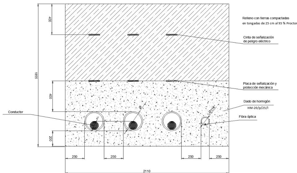
Figura 11. *Detalle de canalización subterránea*
