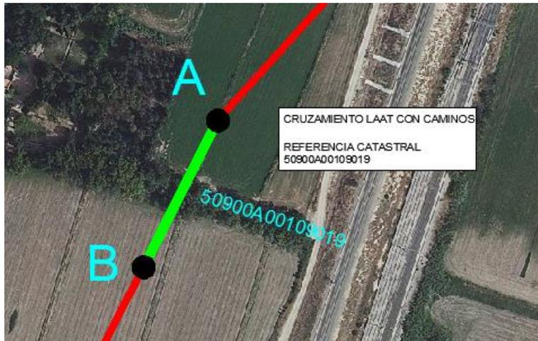
Figura 20. Detalle afección de la línea con camino
