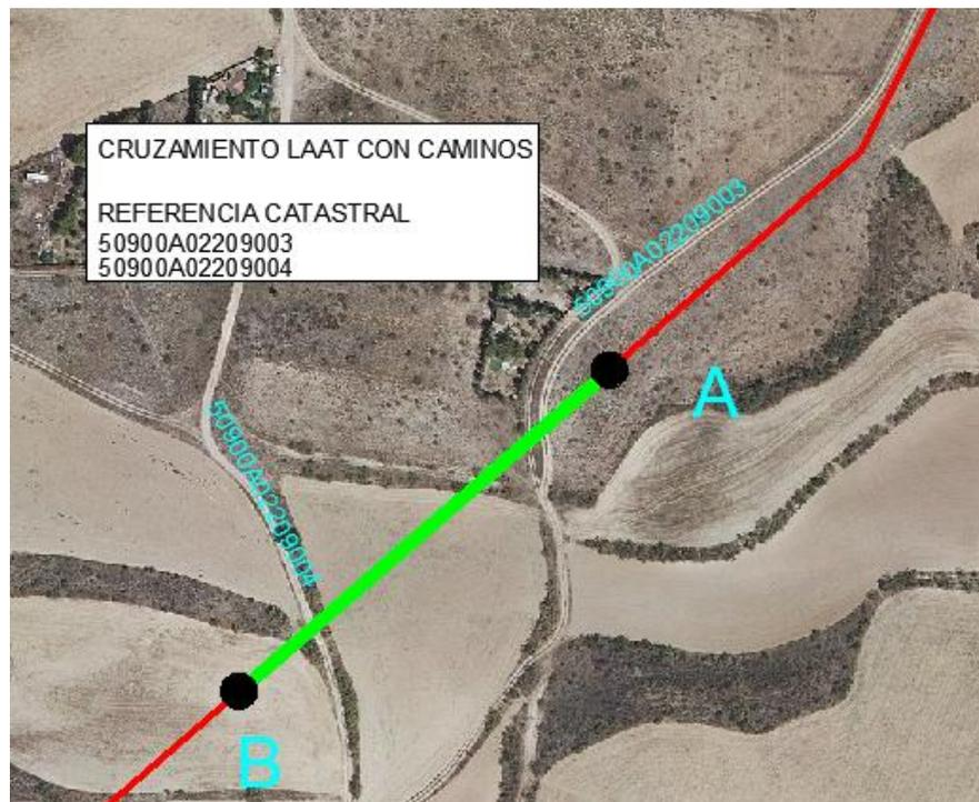
Figura 13. Detalle afección de la línea con camino
