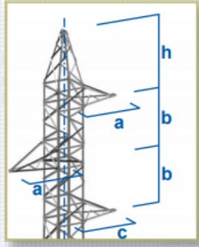
Figura 3. *Detalla constructivo apoyo de celosía con armado tipo "S"*
