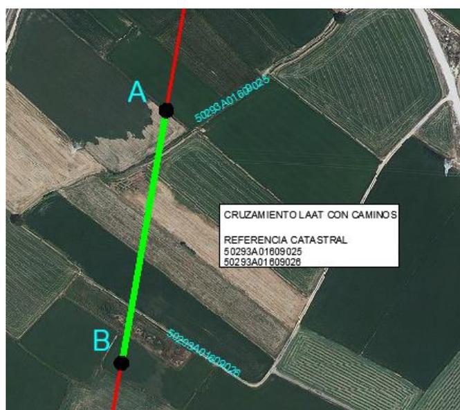
Figura 15. Detalle afección de la línea con camino
