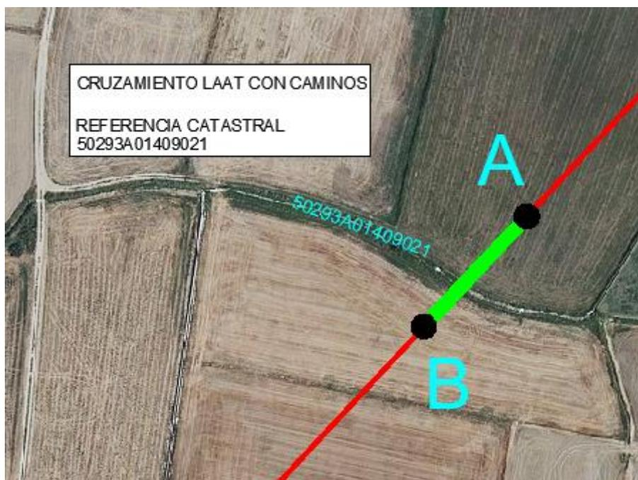
Figura 10. Detalle afección de la línea con camino
