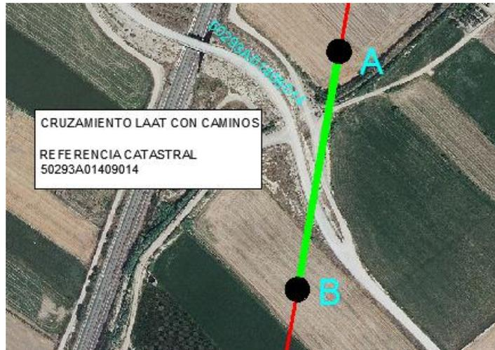
Figura 14. Detalle afección de la línea con camino
