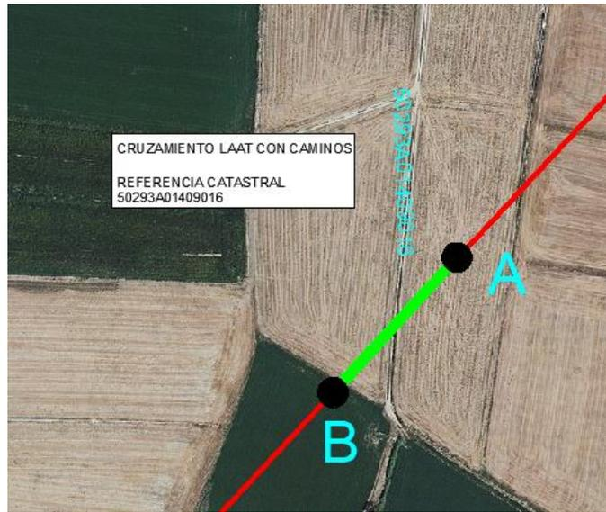
Figura 11. Detalle afección de la línea con camino
